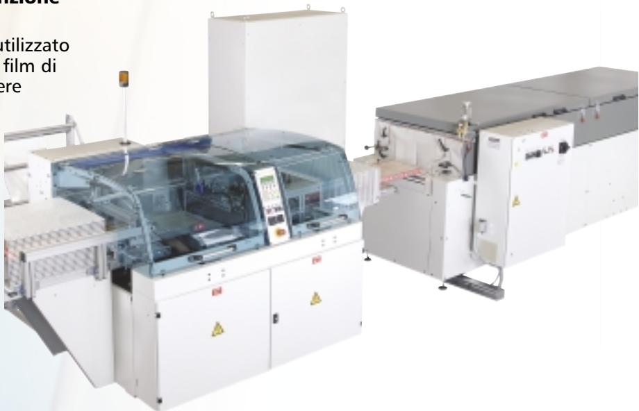
Flexo 500 H con tunnel SLB 5035 per il confezionamento di pannelli
